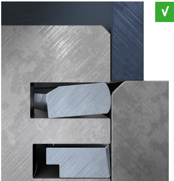
Abb. 2: kleine Fase an der Zylinderbohrung – der Kolbenring gleitet über den Spalt
