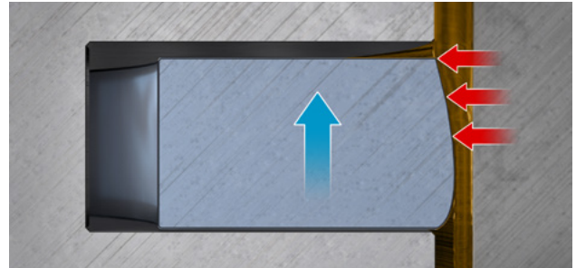
Abb. 4: starkes Aufschwimmen in der Aufwärtsbewegung
