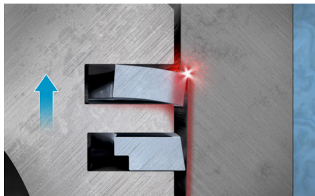
Abb. 3: Anschlagen des Kolbenrings bei neuem Kolben
