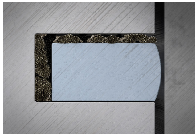
Abb. 1: Schmutzablagerung in der Ringnut
