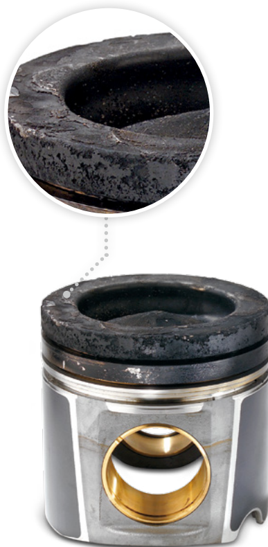
Abb. 3: Ölkohleschicht am Feuersteg
