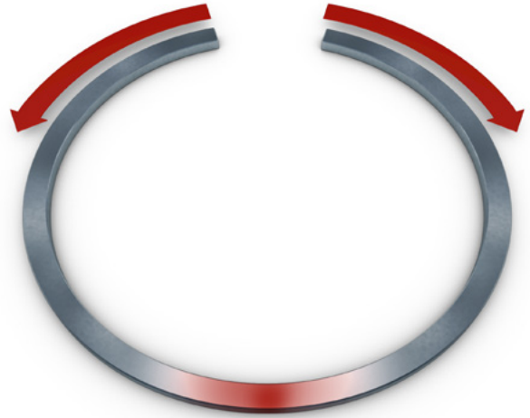
Abb. 1: Übermäßiges Aufspreizen des Kolbenrings
