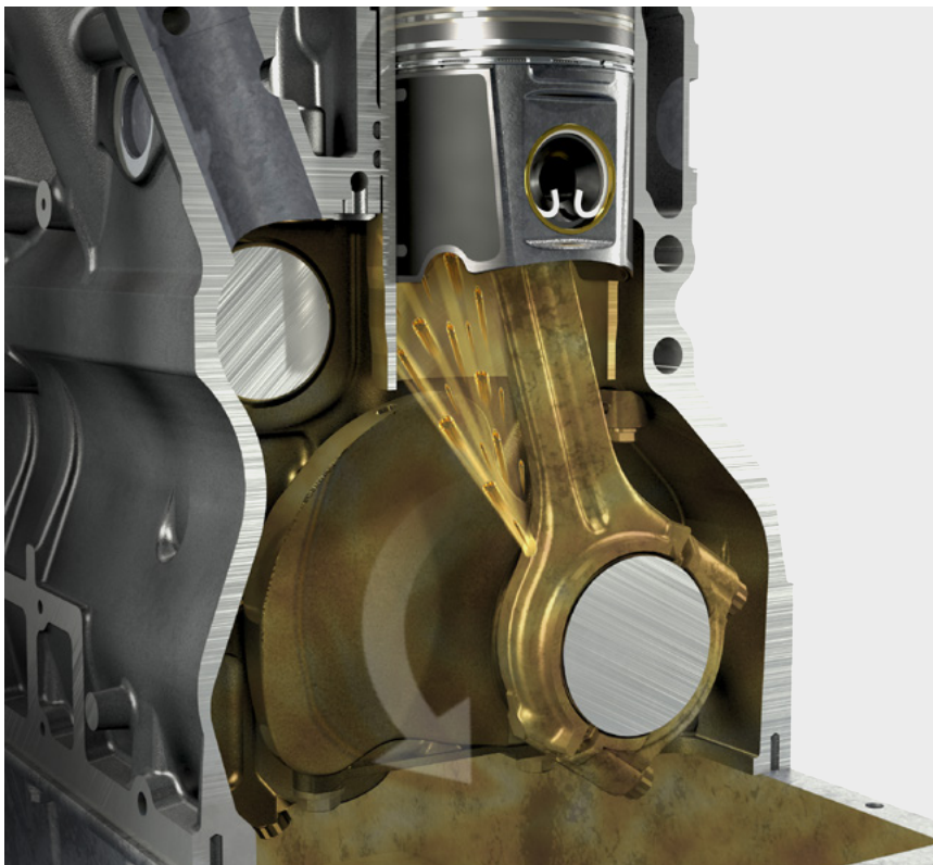
Abb. 1: Ölspritzlöcher im Pleuel garantieren die Schmierung der Lauffläche
