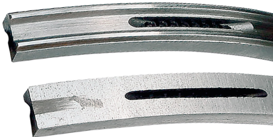
Abb. 3: neuer und verschlissener Ölabstreifring
