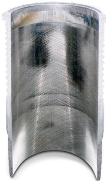
Abb. 2: Glanz und Polierstellen im oberen Zylinderbereich
